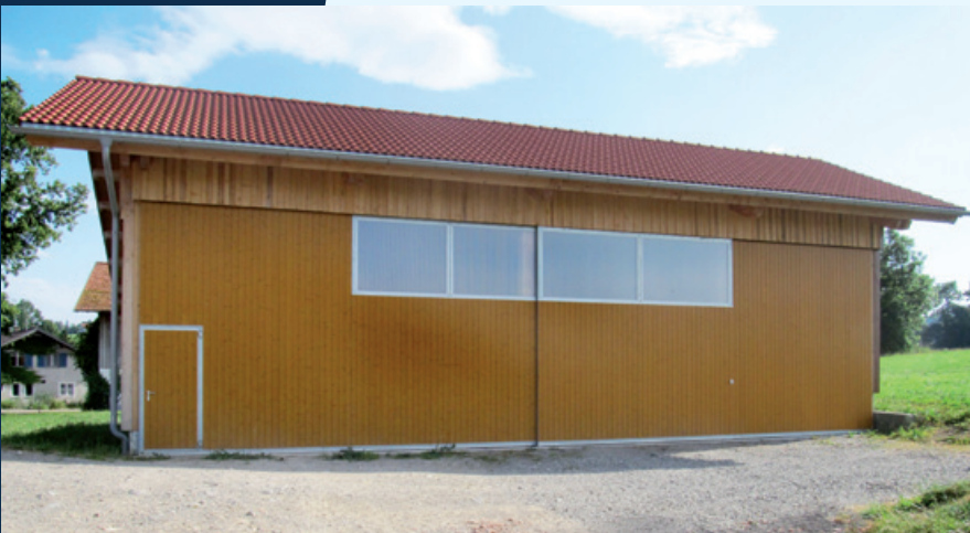
Hallenschubtor mit Holzverschallung, Lichtband und Schlupftüre
